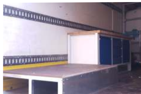
Werkbank und Stellplatz für Bentonitpalette mit integrierter Gestängebox
